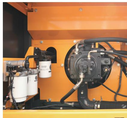
维护保养方便快捷，两级过滤保护发动机，寿命更长
