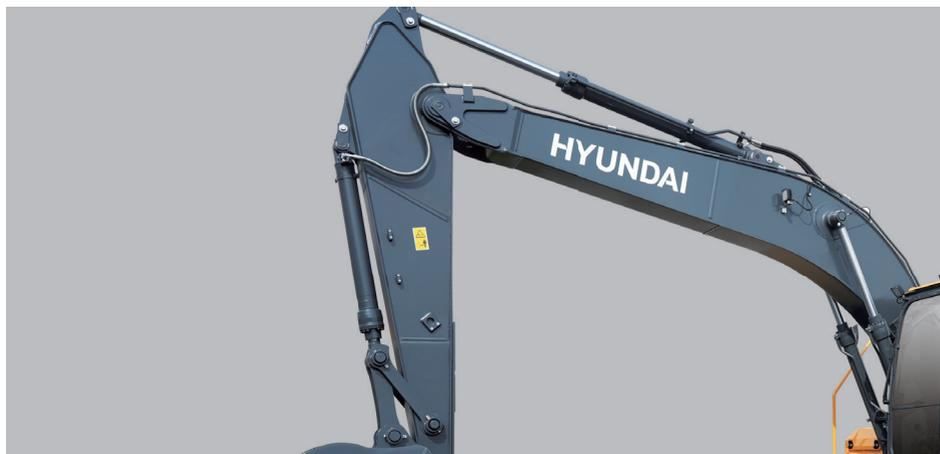
对比HX200小臂标准配置延长2.7m→2.92m；搭载5.675m大臂；扩大作业范围，提升装车作业效率
