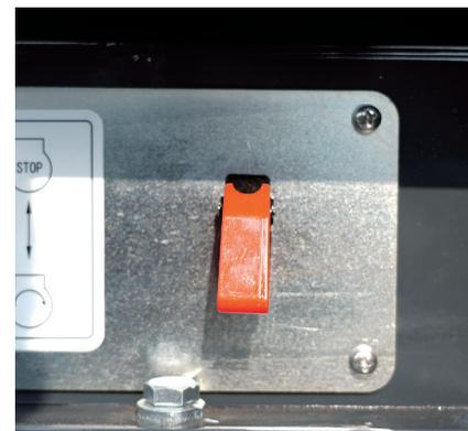
座椅下方标配一键急停开关，无需进入驾驶室即可进行应急操作，保障人车安全
